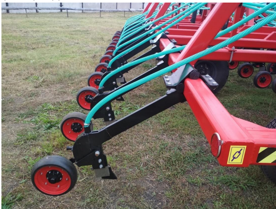
Рис.124 Анкерный демпферный сошник КПК-990А.11.00.000 сеялки А-9900.
