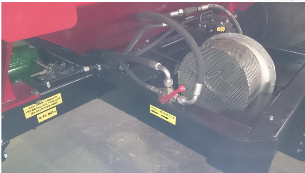
Рис.135 Кран переключения подачи масла к гидромотору вентилятора или гидромотору шнека загрузки (дивертор 3-ходовой DFVIE 3/4).
