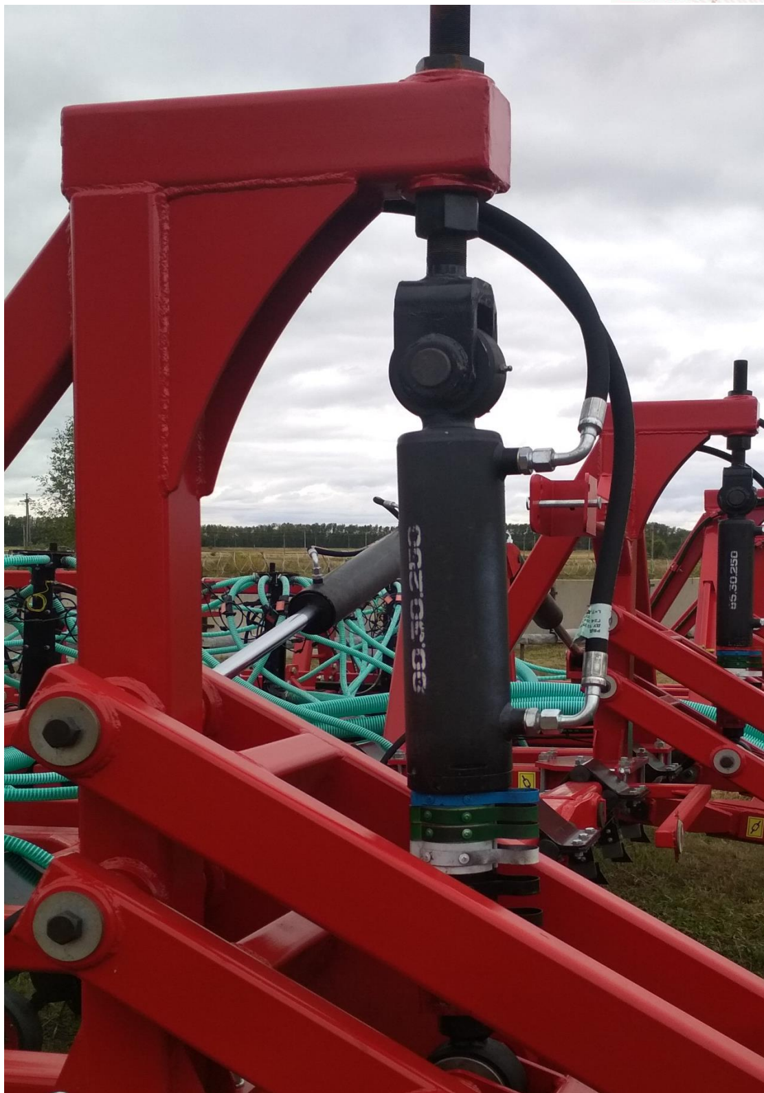
Рис.123 Гидроцилиндр ЕДЦГ 80.30х250К с клипсами регулировки глубины обработки культиваторными лапами.
