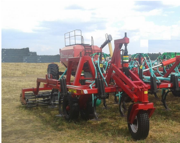
Рис.53 Посевной комплекс с высевом в лапу.
