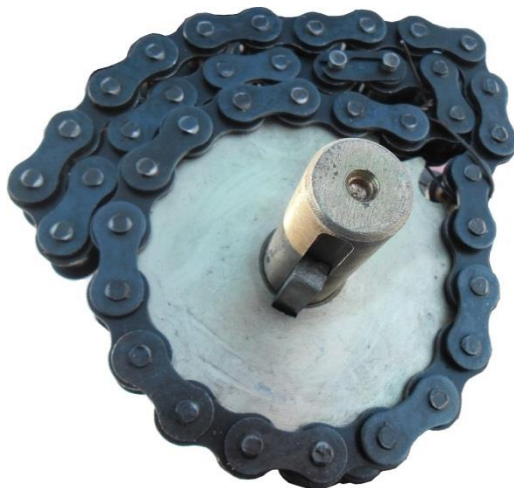
Рис.84 Звездочка 18 зубьев с цепью 40 звеньев с соединением.
