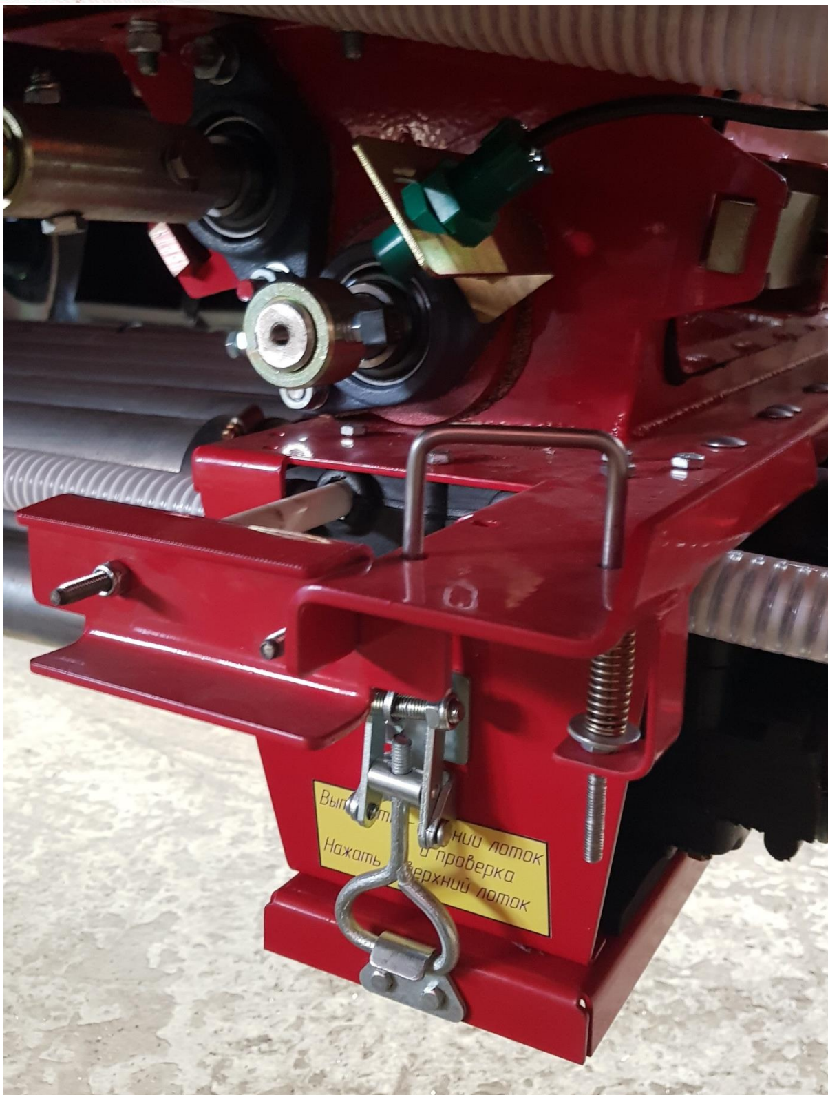
Рис.99 Положение шиберной заслонки, при подаче семян или удобрений в нижние трубопроводы и при тарировке нормы высева двенадцати канального дозатора.
