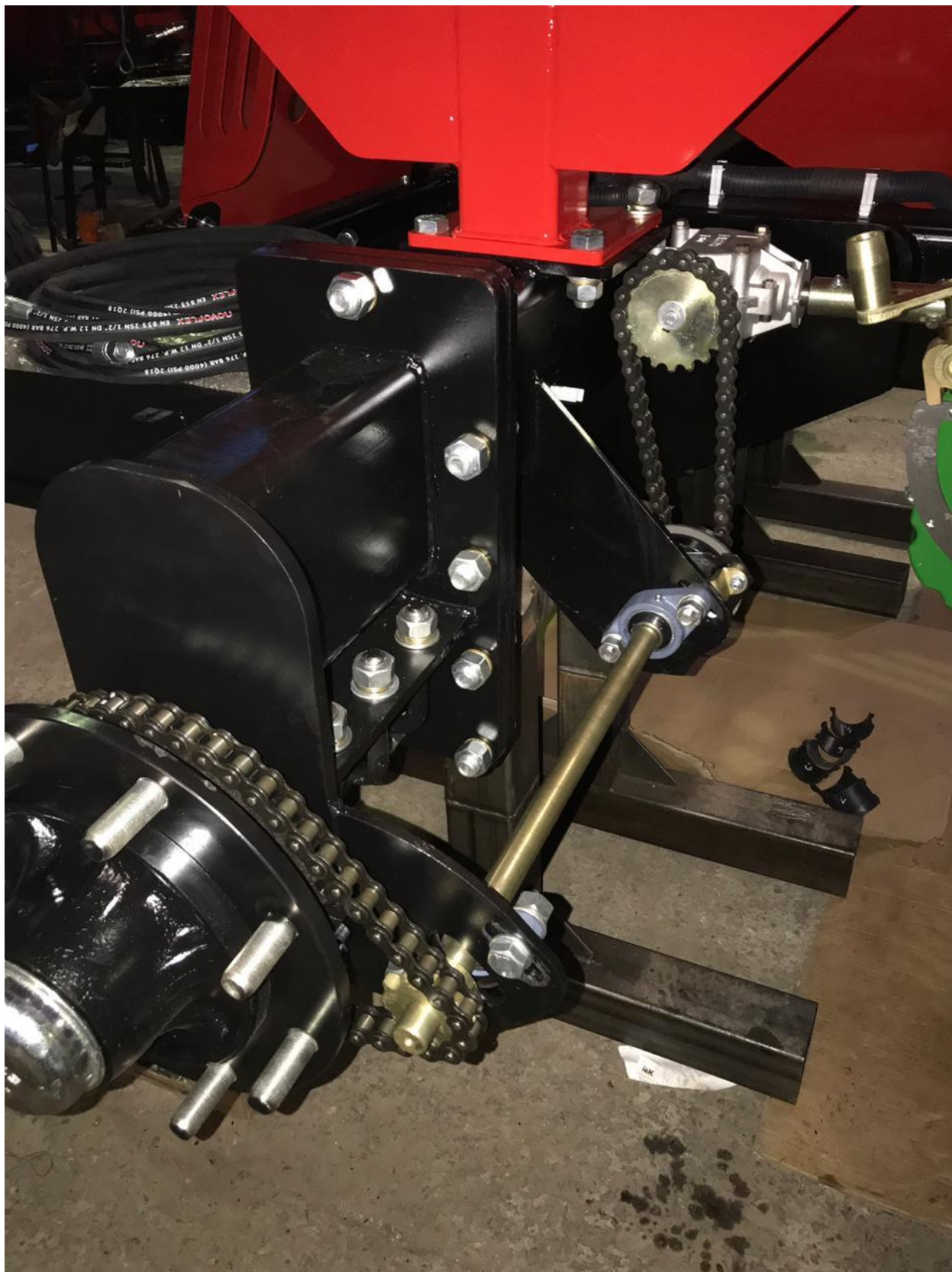
Рис.82 Вал электромагнитной муфты и редуктор привода дозаторов, бункеров ПБ-6-1, ПБ-10-1.
