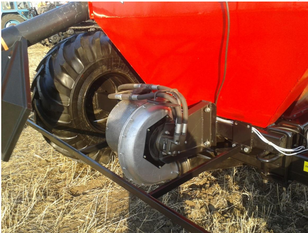
Рис.106 Вентилятор с гидромотором.
