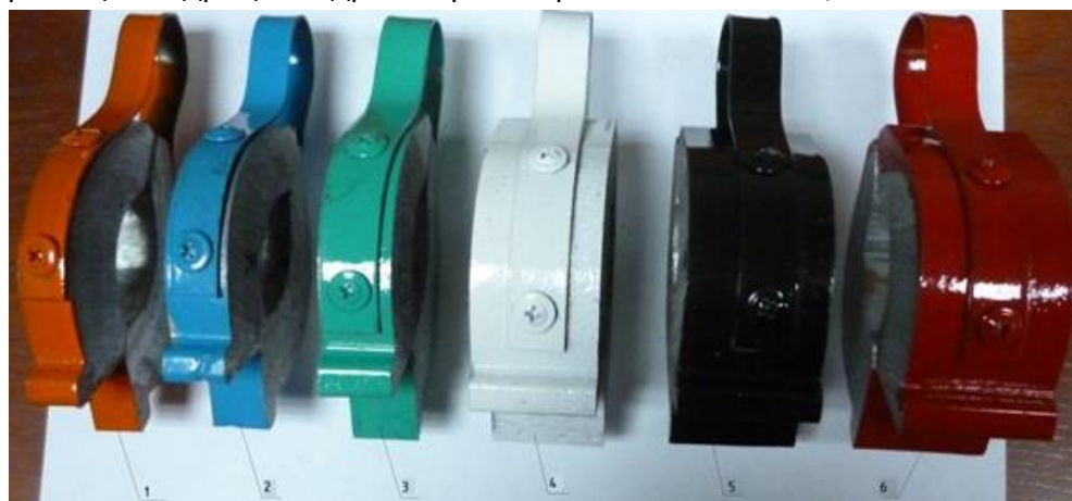
Рис.136 Набор клипс для регулировки глубины обработки культиваторной части посевного комплекса и фиксации гидроцилиндров в транспортном положении.
