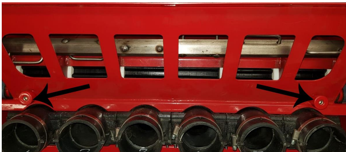
Рис.93 Винты для регулировки зазора между порогом и катушками.
