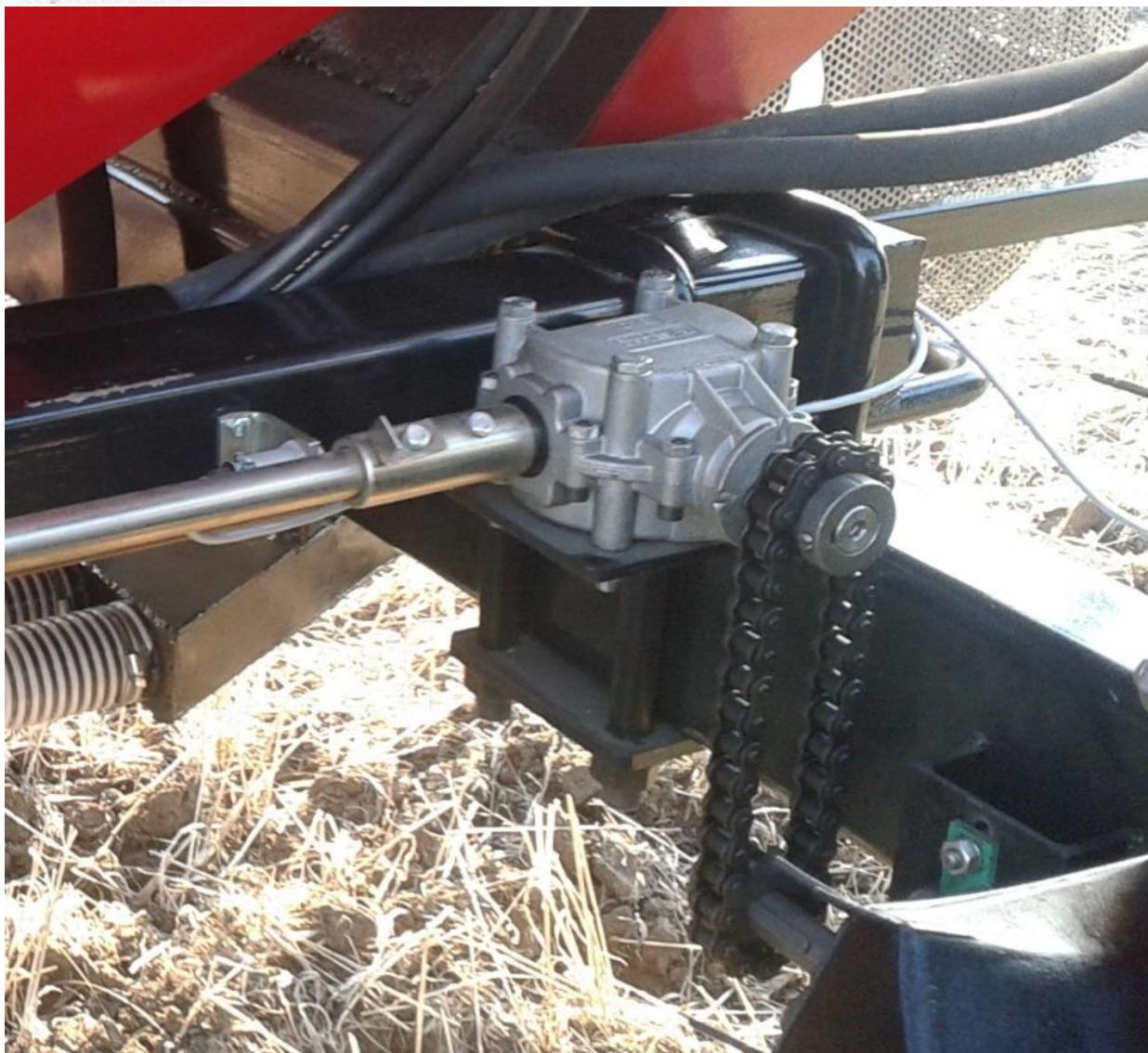
Рис.80 Редуктор привода дозаторов, бункера ПБ-6-2, ПБ-10-2.
