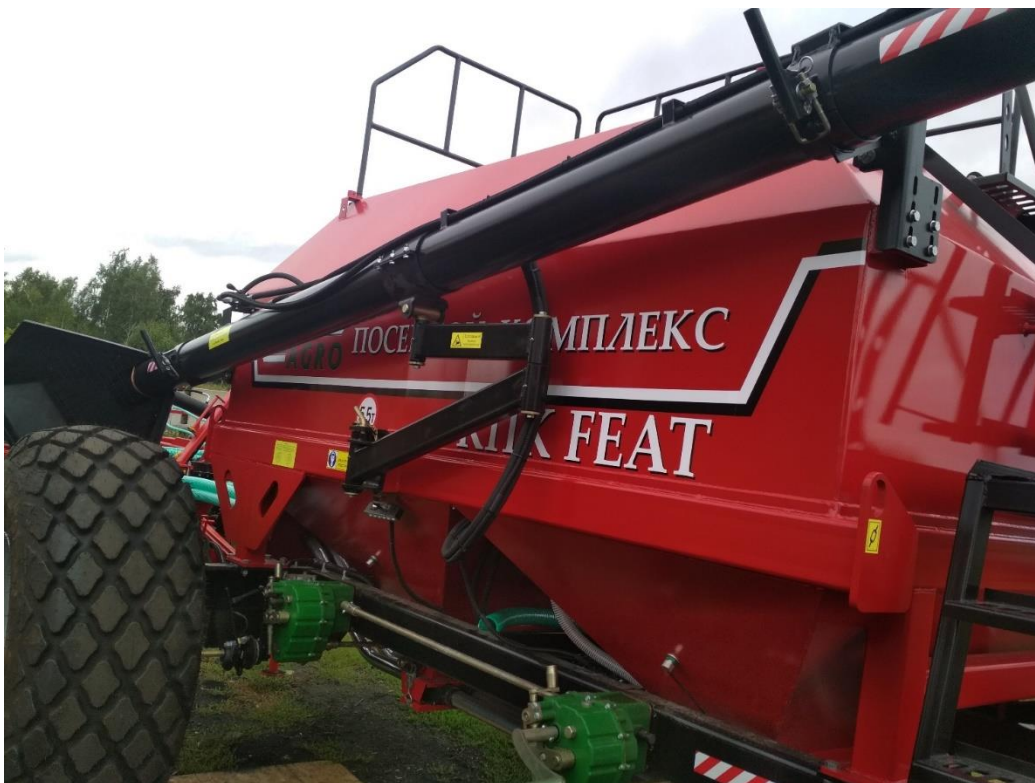
Рис.72 Шнек в положении транспортировки и хранения.
