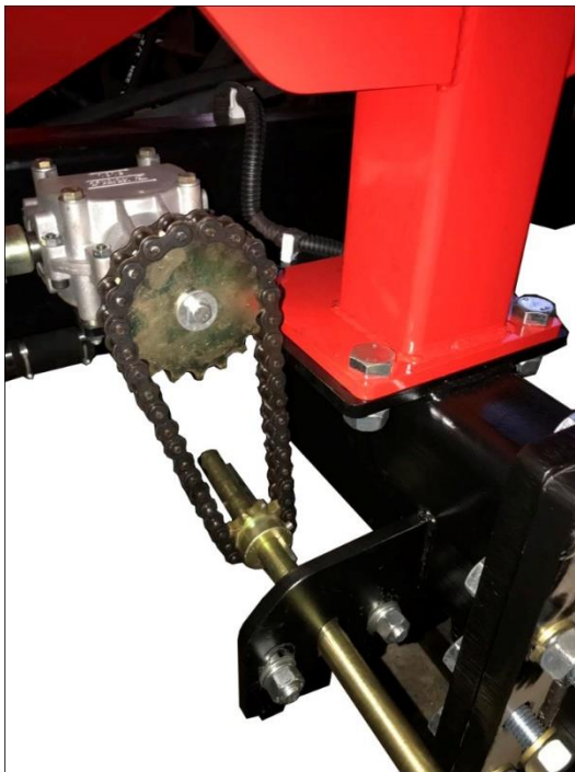
Рис.86 Звездочка 18 зубьев на валу редуктора для уменьшения нормы высева.
