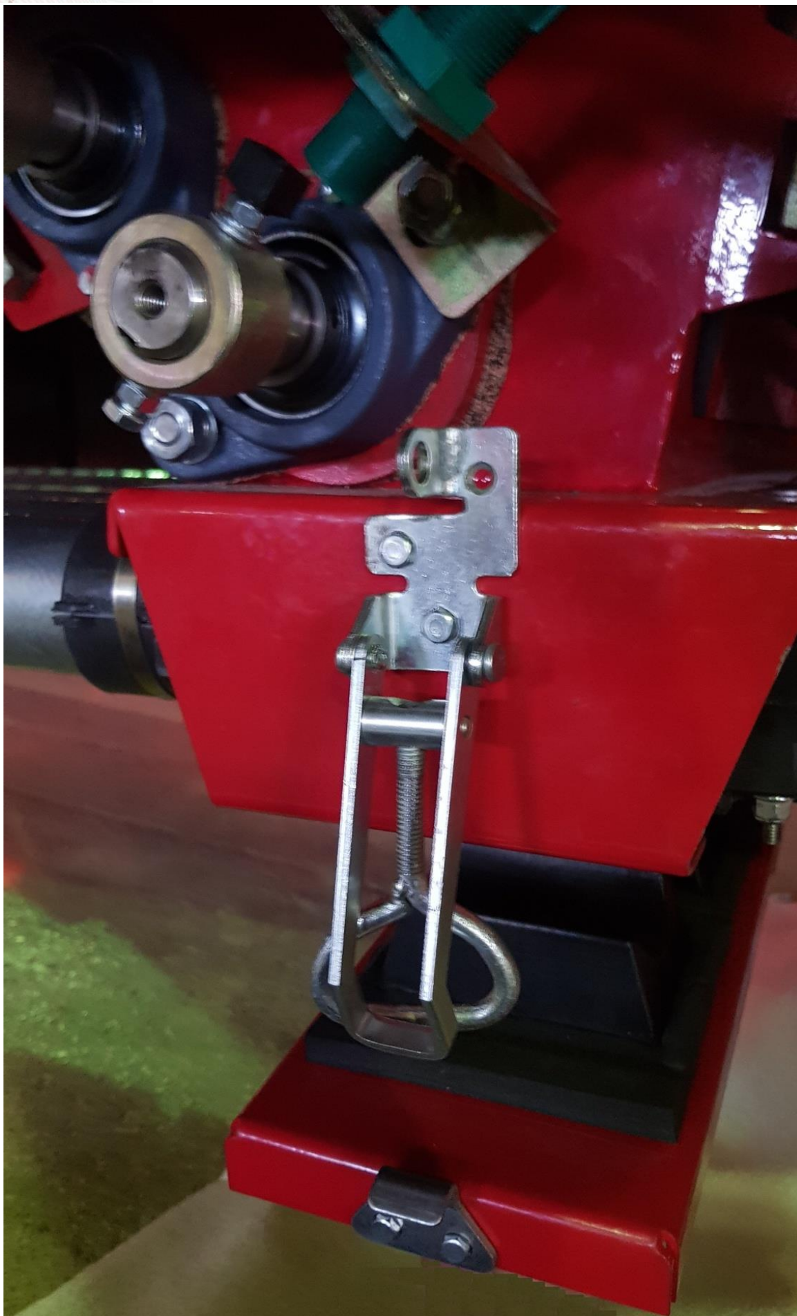
Рис.97 Снятие нижней крышки для тарировки нормы высева в шестиканальном дозаторе.
